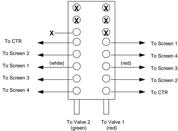
Figure II-4. Air Manifold
